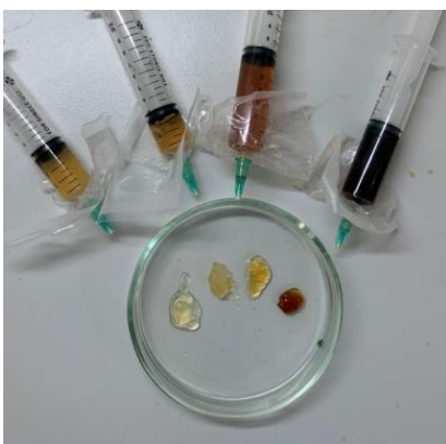
Рис. 3. Гели на основе БСА с добавлением гистидина (слева направо): 1 — в отсутствие регулирования pH, 2 — в фосфатном буферном растворе, 3 — в ацетатном, 4 — в оксалатном
