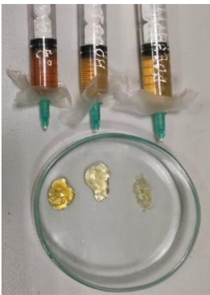
Рис. 2. Гели на основе БСА: слева — с добавлением дибазола при термостатировании, в центре — эталон (выдержанный в термостате, без добавления гетероциклических соединений), справа — с добавлением дибазола, оставленный при комнатной температуре
